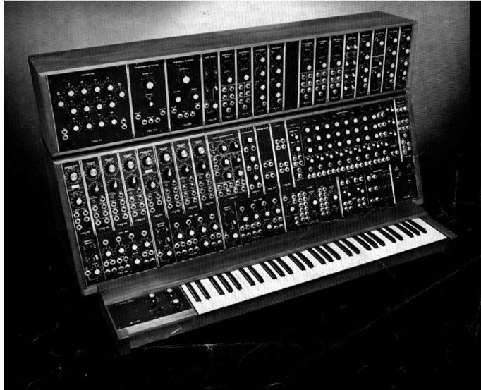
Os Moog mais sofisticados eram os "modulares". Os módulos de criação de sons podiam ser adquiridos conforme a necessidade, contudo o preço era muito alto, acima dos U\$ 10.000,00 , e muito complicado de se operar. Podiam chegar ao tamanho de uma parede e os módulos eram interligados com cabos , como os de uma telefonista.
